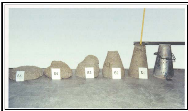
Figura 6.5 – Calcestruzzi a classe di consistenza crescente da destra a sinistra accanto al cono di Abrams
